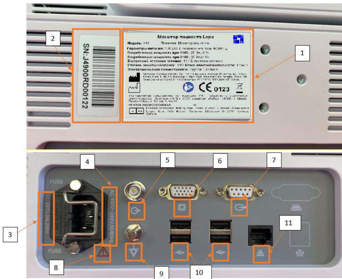
Рисунок 26.15.2 – Информация, нанесенная на заднюю сторону монитора пациента K15 (для вариантов исполнения K10 и K12 – аналогично)
