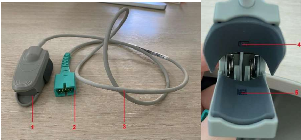
Рисунок 2.2.2 – Датчик пульсоксиметрии для взрослых (Датчик пульсоксиметрии для детей отличается только размером датчика пульсоксиметрии, конструкция – аналогична)
