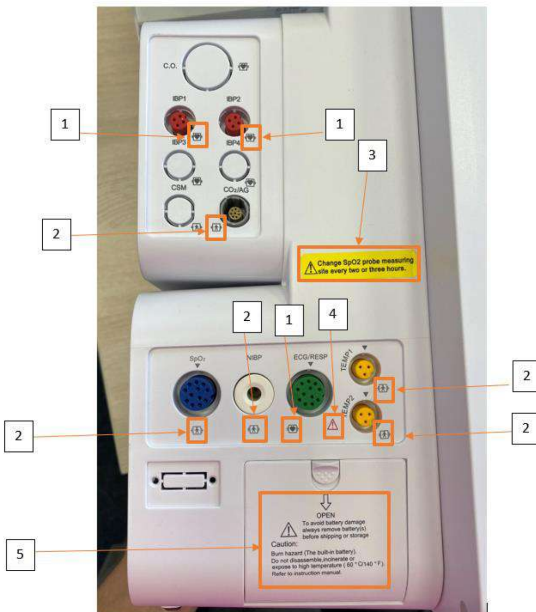
Рисунок 26.15.3 – Информация, нанесенная на левую сторону монитора пациента K15 (для вариантов исполнения K10 и K12 – аналогично)
